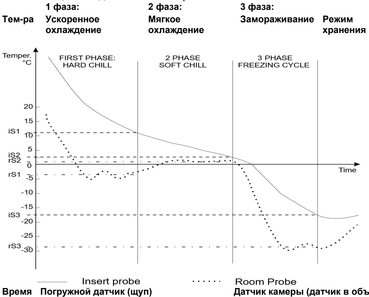
Рис. 13 Схема цикла мягкой заморозки
